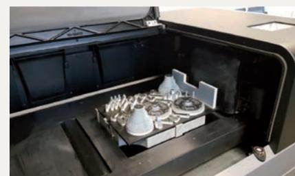
Machine de prototypage rapide 3D Systems.
