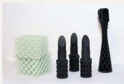
Exemples de pièces imprimées sur la machine Carbon
