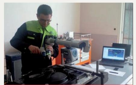
Bras de mesure laser Faro pour la réalisation de compléments de mesures tridimensionnelles.
