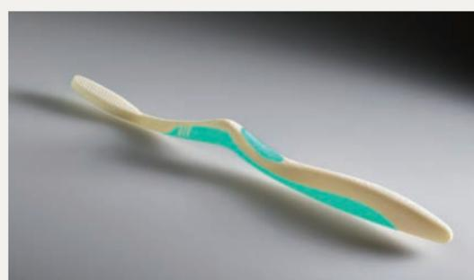
Les nouvelles FreeFormer 200 et 300-3X Arburg peuvent mettre en œuvre 2 et 3 polymères simultanément.
