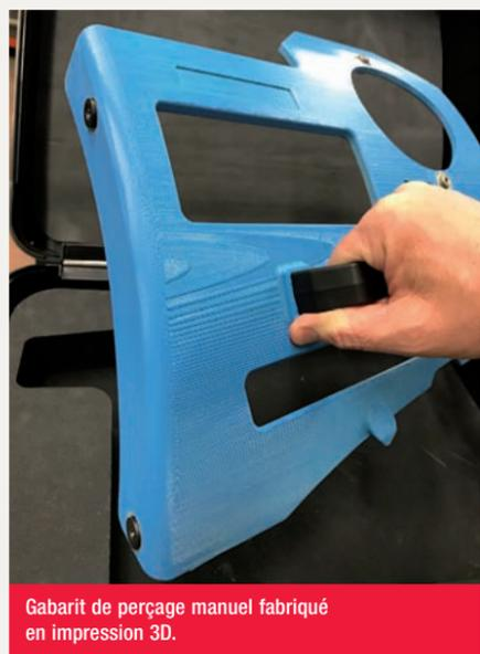
Gabarit de perçage manuel fabriqué en impression 3D.
