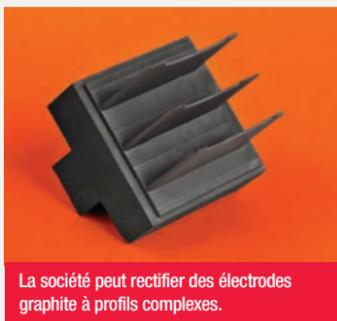
La société peut rectifier des électrodes graphite à profils complexes.
