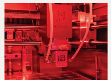
Les imprimantes Roboze One + 400 Xtreme dotées de la technologie HVP sont conçues pour transformer des polymères très visqueux comme le PEEK.
