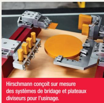
Hirschmann conçoit sur mesure des systèmes de bridage et plateaux diviseurs pour l'usinage.
