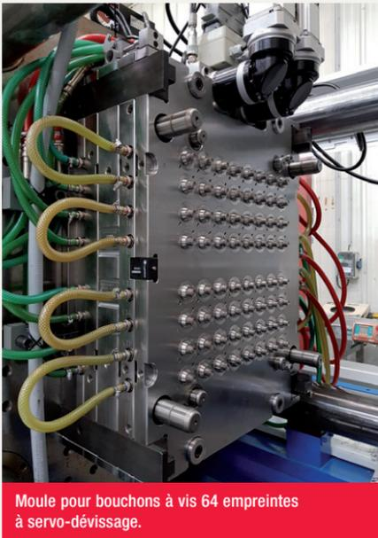
Moule pour bouchons à vis 64 empreintes à servo-dévissage.
