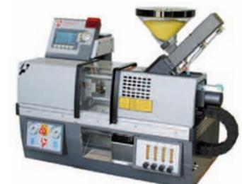
**Mini presse à injecter** hydraulique 6,25 tonnes mono matière de 4 à 36 cm<sup>3</sup>
