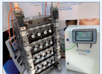
**L'EIMC (Electric In-Mould Closing) permet d'intégrer directement dans l'outillage une opération de fermeture automatisée des bouchons et capsules service. Opérée lors de l'ouverture du moule en une fraction de seconde par des systèmes mécaniques servo-commandés, cette opération est beaucoup plus rapide et fiable que les techniques conventionnelles opérant en sortie de presse. L'EIMC augmente considérablement la productivité d'une cellule de moulage.**
