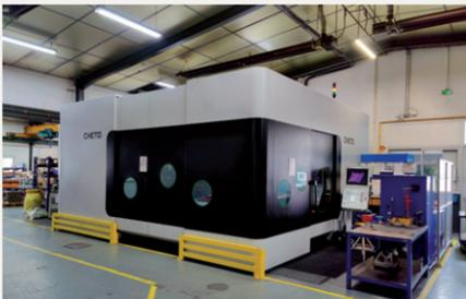
Les centres Cheto Cheto peuvent opérer sur une même machine fraisage, perçage, taraudage et forage profond.
