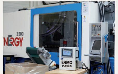
Le MAC2S (Mold Alignment Continuous Safety System) est un système breveté par ERMO pour contrôler l'alignement du moule. Il contribue à la mise en place d'une maintenance préventive efficace.
