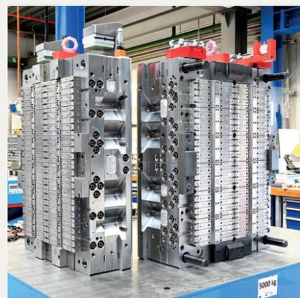
Moule à 96 empreintes avec injection latérale directe pour la fabrication d'un piston en PS pour seringues de 1 ml. (@Hack)
