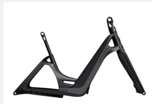
Ces composants du VAE Multipath intègrent de la fibre de carbone recyclée.
