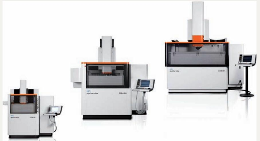
Les équipements d'enfonçage par étincelage FORM 300 de GF Machining Solution sont dotés du générateur ISPG (Intelligent Speed Power Generator) qui optimise la qualité de surface, d'enlèvement de matière et de précision de la forme.
