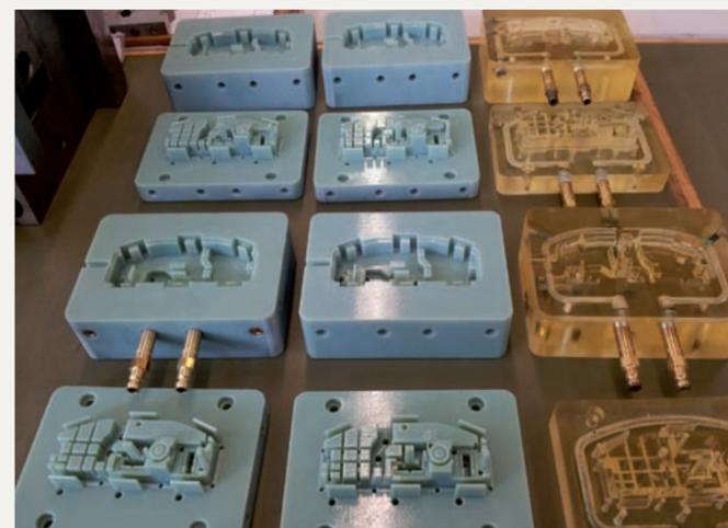
L'impression 3D se prête à la fabrication de moules pour pièces à géométries complexes et parois fines, en conservant des détails précis.
