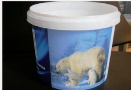
Grâce au nouveau moule conçu par Collomb Mécanique, ce seau de 5 l ne pèse que 90 g, contre 140 g avec un outillage conventionnel.
