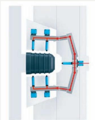
Grâce à ses articulations, le système canaux chaud Rheo-Pro Slide peut changer de forme afin de maintenir l'alimentation matière des points d'injection pendant certains mouvements du moule.
