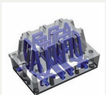
Le frittage sélectif par laser permet de rapprocher le plus possible les canaux de refroidissement des surfaces moulantes des empreintes.
