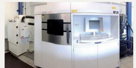
La machine de frittage laser sélectif EOS, et à gauche le four de finition des pièces.
