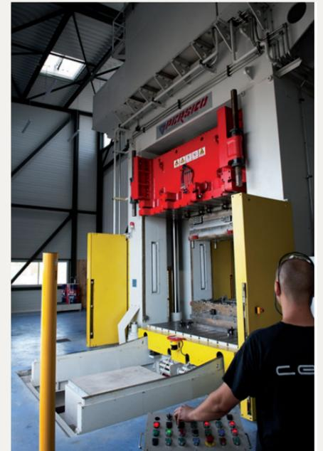
La presse de compression de classe industrielle permet de réaliser des développements et essais de moules (RTM y compris) avec des matériaux thermoplastiques, thermodurs (SMC).
