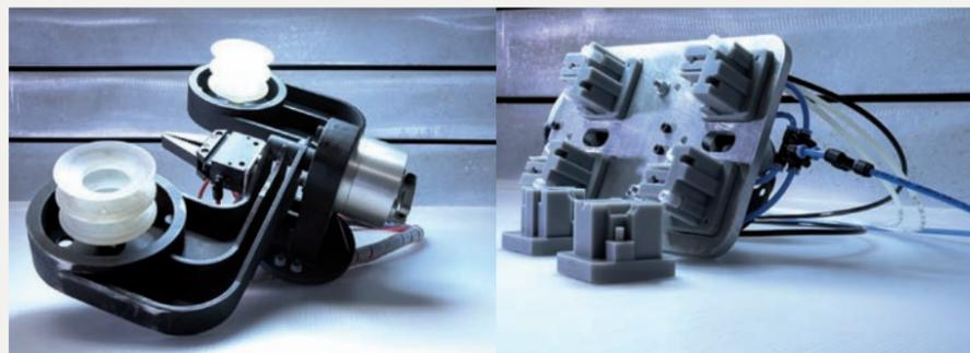
Les mains de préhension de robots imprimées sur mesures sont un important marché, de même que les gabarits de contrôle.
