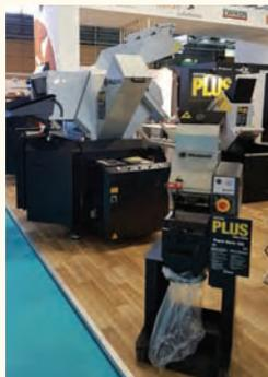
L'offre Rapid complète était exposée au FIP. Au premier plan, un broyeur Série 150 pour le recyclage direct des carottes en pied de presse.
