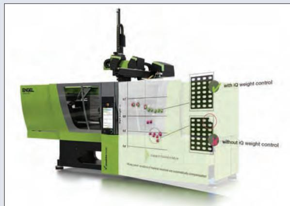
Le système iQ Weight Control équilibre les variations de process avant que des pièces mauvaises ne soient produites. Engel a étendu cette fonctionnalité à ses presses hydrauliques.
