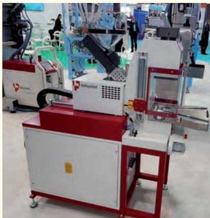
Les micro-presses à injecter Babyplast existent en 4 versions, dont une pour la bi-injection.
