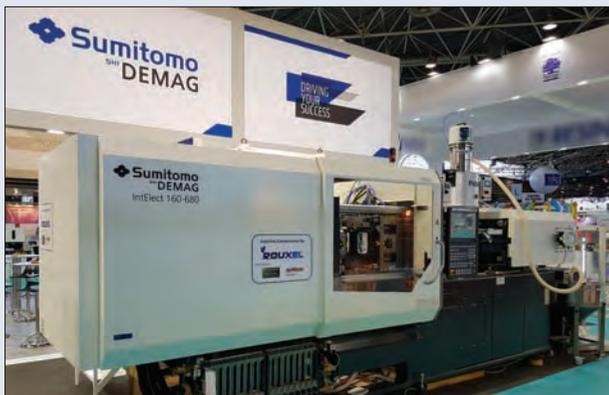
Cette presse IntElect de 160 t était équipée du système Toptec pour injecter à haute cadence des pièces à paroi mince.
