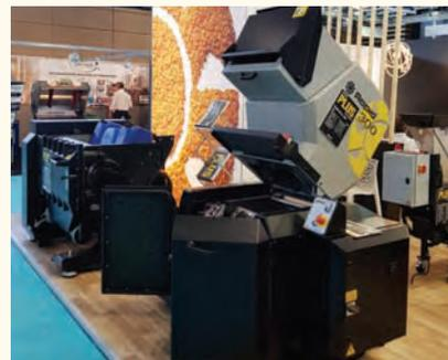
Les broyeurs Série 300 sont utilisés en centralisé ou à côté des machines en injection, soufflage, extrusion et recyclage, avec des débits jusqu'à 500 kg/h.
