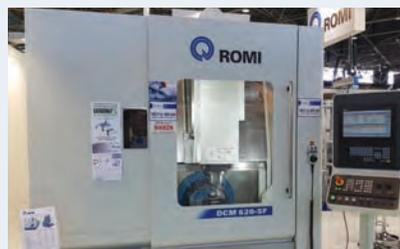
**Centre d'usinage vertical 5 axes à c.n.**
