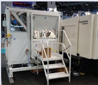
La machine Intelect 160 t était équipée d'une station automatique de pose d'étiquettes IML Machines Pagès.
