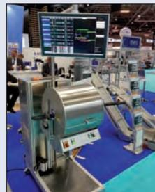
Le système de contrôle Pixargus peut contrôler visuellement à 360° une surface extrudée défilant jusqu'à 300 m/mn.
