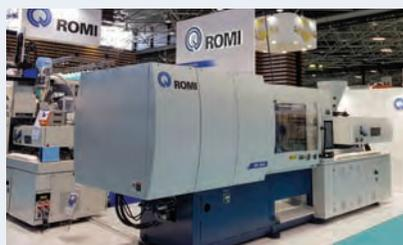
**Presse servo-hydraulique EN 300 t. Les presses ROMI sont équipées de composants européens, par exemple de pupitres de commande B+R full HD.**
