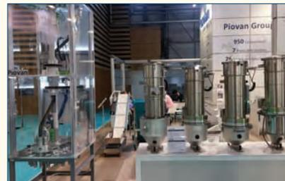
Éléments de systèmes de gestion centralisée des matières : station de couplage automatique EasyLink (à gauche) et chargeurs PureFlo
