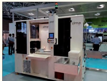
Cellule de décoration par tampographie dotée de systèmes de prétraitement plasma et de séchage infrarouge.
