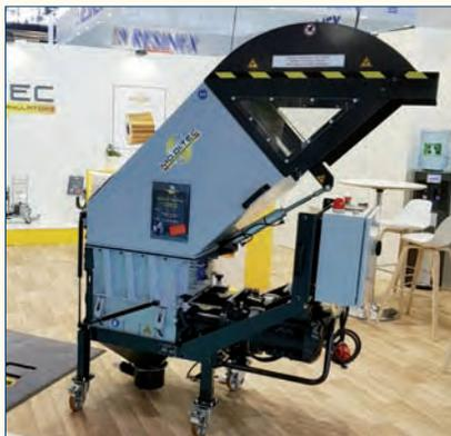
Ce broyeur à forte capacité Goliath Twin Plus était doté d'un couvercle motorisé automatique.
