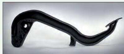
**Moulée par injection-eau en PA AKROMID B3 ICF 15, cette pédale est 10 % plus légère et 25 % plus rigide que son équivalent en PA 6 renforcé 30 % f.v.**
