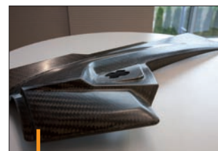
Pièce composite équipant la voiture de sport KTM X-Bow produite sur une presse Engel verticale V-Duo 700 avec une unité de moulage PU Hennecke.
