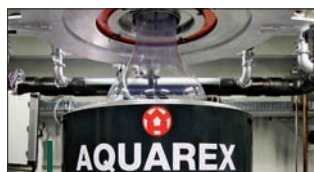
Les lignes d'extrusion-gonflage Aquarex extrudent la bulle vers le bas afin de refroidir rapidement le film dans un bain d'eau.
