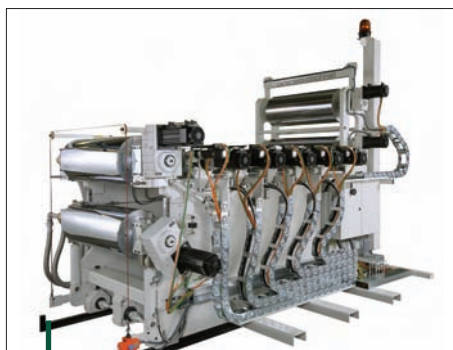
Avec ses 5 ou 7 cylindres, la calandre de lissage Multi-Touch procure une plus grande capacité de refroidissement sur les deux faces du film.
