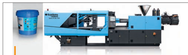
Presse hybride Systec de 280 t présentée en version SP pour la production de seaux en PP de 1,2 l sur un outillage à 2 empreintes.
