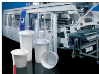
Gobelets thermoformés sur machine Gabler M98 dotée d'un moule basculant 60 empreintes.
