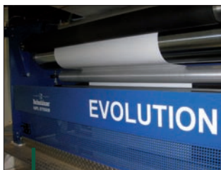
Le nouveau module de mise à plat de la gaine développé par Reifenhäuser permet d'étirer plus facilement le film sans dépenser d'énergie.
