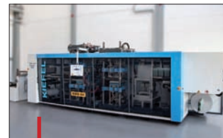
Machine KMD équipée du nouvel empileur horizontal adapté aux plateaux thermoformés.
