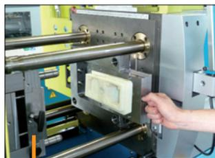
Inserts de moules réalisés par impression 3D pour faciliter l'industrialisation de nouvelles pièces.
