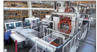
Outre du PP, la machine OMV RM77 Revolver peut thermoformer du PS, du PLA, du PET et des feuilles multicouches.
