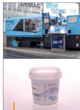
Cette presse El-Exis SP 200 produit 4 pots en PP décorés par IML dans un temps de cycle inférieur à 2 s.
