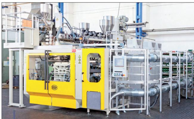
Avec l'EBlow 37, la production de bidons de 10 à 35 l passe en mode électrique à haute cadence.
