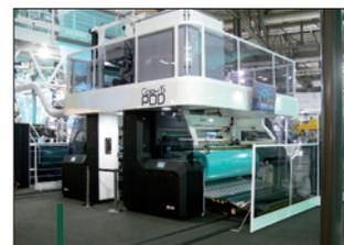
Macchi expose une ligne POD de coextrusion de films polyoléfines 5 couches
