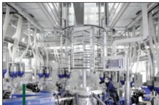
Les lignes de coextrusion Reifenhäuser bénéficient des nouvelles têtes modulaires Evolution Ultra Flat
