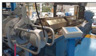
Ligne d'extrusion de PVC équipée d'un filtre Fimic RAS400.
