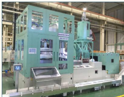
Machine d'injection-soufflage Aoki SBIII-500-150 pour la production de pots à large ouverture.
