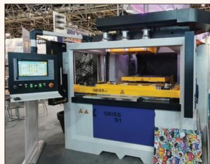
Machine de formage Geiss TS1 pour la réalisation de pièces prototypes ou petites séries : petites dimensions, mais haute précision.
