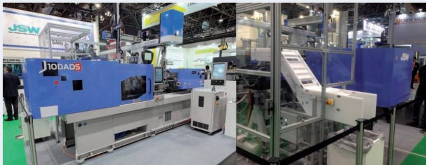
Cette presse JSW était équipée côté non-opérateur d'une unité d'injection auxiliaire Flip20 montée en position horizontale. A droite : un convoyeur Syscon conçu par Farpi était placé en arrière le long de l'unité Flip20.
