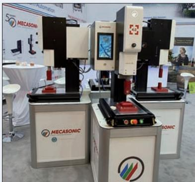
Le grand écran tactile qui facilite la programmation des soudeuses Omega 4 et le suivi des opérations d'assemblage.
