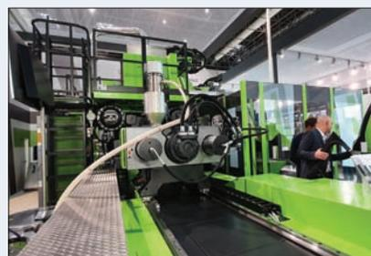
Sur cette Duo de 800 t produisant des pièces composites, l'ensemble des robots, systèmes d'automatisation et fours étaient commandés par l'armoire Engel CC300.
