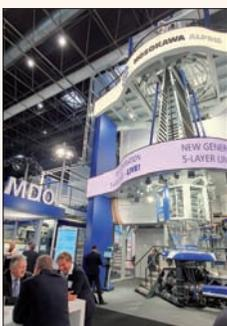
Cette ligne Alpine de coextrusion 5 couches était équipée d'un système de mono-étrirage MDO.
