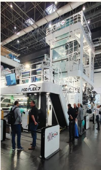
La ligne POD FLEX 7 couches était équipée de la dernière génération d'extrudeuses Macchi et d'un nouvel enrouleur automatique BO-Plus.
