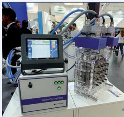
Le ServoControl est l'armoire dédiée aux mouvements des plaques actionnant les tiges d'obturation.
