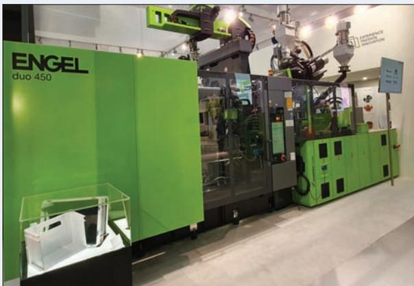
Cette Combi Duo 450 produisait des caisses de transport en PP vierge/PP recyclé à l'aide du nouveau procédé Skinmelt, différent d'une co-injection sandwich classique.
