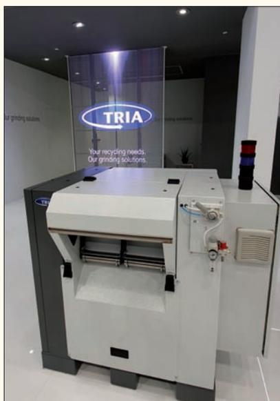
Les broyeurs Tria XR sont conçus pour le recyclage en ligne des lisières et squelettes de thermoformage.
