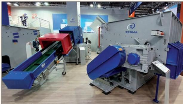
Les broyeurs mono-rotor Zerma ZHS sont conçus pour traiter des produits imposants, tels que purges, segments de tuyaux et balles.
