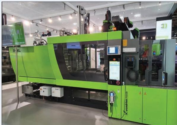
Pour réduire leur consommation électrique, les presses sans-colonne Victory bénéficient du système servo-hydraulique Ecodrive.
