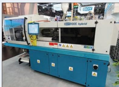
**Cette presse de 100 t est équipée de la nouvelle unité d'injection électrique eSP.**
