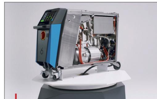
Les régulateurs Serie 6 sont équipés de pompes à vitesse variable à entraînement direct offrant un rendement jusqu'à 20 % supérieur.
