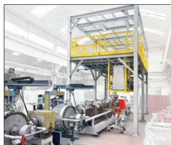
Ligne ICMA équipée d'une extrudeuse bivis de 110 mm de diamètre de vis.
