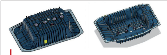
Cette pièce de coffre automobile allégée est réalisée par injection et surmoulage d'organo-sheet.
