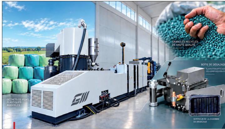
Les installations GM Tandem assurent un recyclage efficace des déchets plastiques agricoles.
