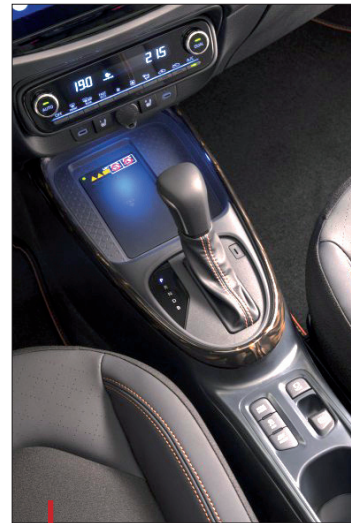
La console de la Toyota Aygo X, une réalisation illustrant les nombreux savoir-faire de Plastivaloire dans la décoration des pièces plastiques, notamment par In-Mold Color.
