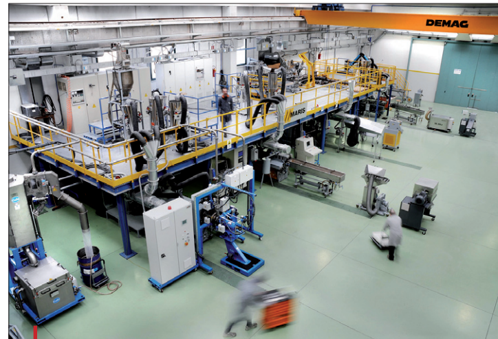
Le centre technique met en permanence 4 lignes de compoundage à disposition des essais clients.
