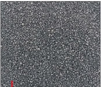
Le Sopacolor Carb-G est une charge additive colorée fabriquée à partir de carbonate de calcium naturel.
