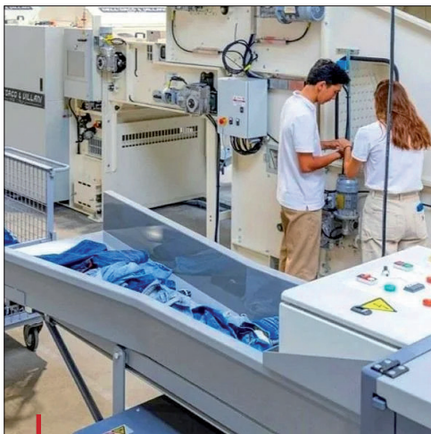
Carbios a doté son centre de démonstration de Clermont-Ferrand d'une ligne automatisée qui transforme les déchets textiles provenant de vêtements usagés ou de chutes de coupe en matière première adaptée à la dépolymérisation.
