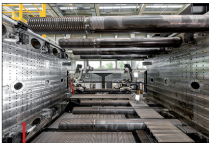
Cette machine peut injecter des pièces ayant une surface projetée supérieure à 2,5 m².
