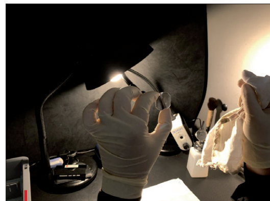
Contrôle qualité d'un produit optique sous hotte à flux laminaire noir, afin d'examiner les imperfections de surface conformément à la norme ISO 10110.
