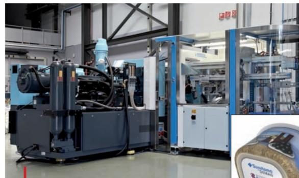
Cellule pour la production à haute cadence (3 s/cycle) de barquettes en PP (250 g) avec IML enveloppant dotée d'une presse hybride EL-Exis SP 200 et d'un moule Marbach 2 empreintes.
