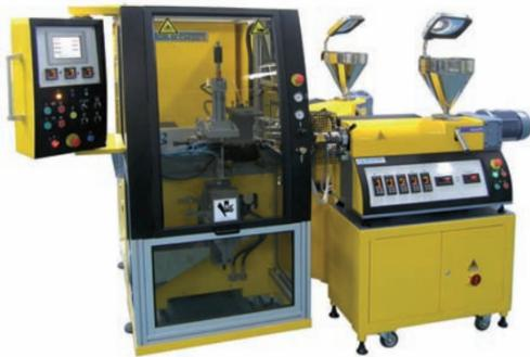
Ligne de coextrusion-soufflage de corps creux en laboratoire Labtech Engineering.
