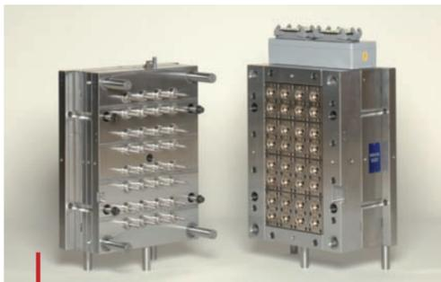
Le système canaux chauds optimisé de ce moule 32 empreintes pour corps de seringues en PP de 2 ml a permis de diminuer le poids matière de 10 % et de réduire le temps de cycle.
