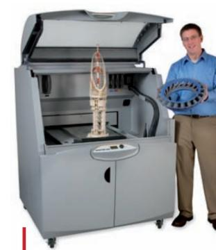
Le développement des gammes Z Corp continue après le rachat par 3D Systems, avec ce nouveau modèle d'imprimante ZPrinter 850 qui offre une taille de construction de 508 x 381 x 229 mm.
