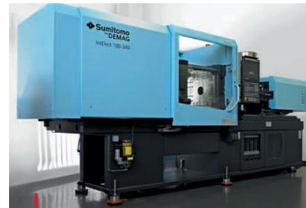
Presse IntElec 100-340 équipée du clapet anti-retour ActiveLock permettant d'éliminer l'une des principales sources de variabilité des poids de matière injectée dans les empreintes.
