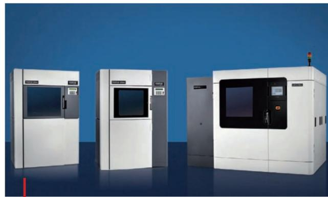
Machine Fortus autorisant le moulage par fabrication additive de pièces bonne matière en ABS, PC, PPS et PEI Ultem.
