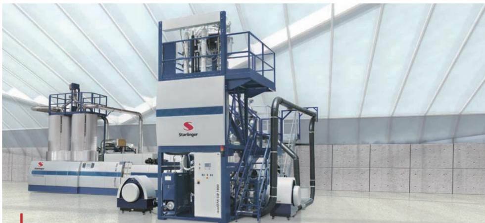
Globalement, les lignes de recyclage RecoSTAR PET offrent des capacités de production de 150 à 3 600 kg/h.
