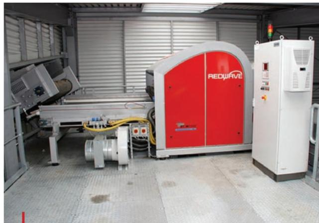
Les systèmes de détection Redwave permettent de trier sur deux ou trois voies de grandes quantités de déchets, jusqu'à 8 t/h.
