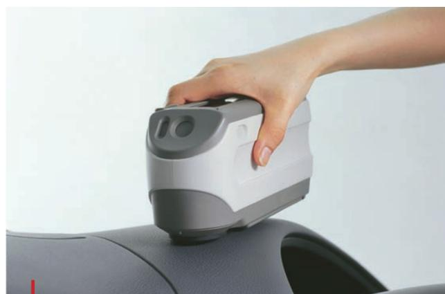
La version CT du CM-2500c offre ergonomie, précision et répétabilité dans la mesure de couleur sur différents types de pièces automobiles.
