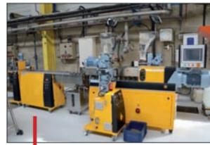
La ligne de compoundage Labtech basée sur une extrudeuse bivis corotative permet de tester et optimiser les formulations.
