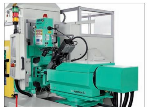
Arburg a développé cette unité de micro-injection équipée de deux étages pour la plastification et l'injection en mode FIFO.
