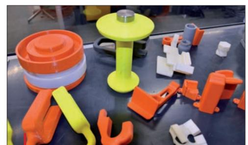
La machine de fabrication additive 3D Fortus permet à Volvo trucks de réaliser rapidement et à bon compte toutes sortes de fixations, supports et gabarits.
