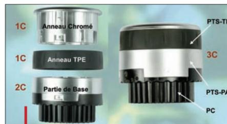
Ce bouton de commande de tableau de bord BMW est désormais produit pour un coût inférieur de 50 % par tri-injection de trois compounds PC, PA renforcé 40 % f.v. et PP-EPDM. PTS a réussi à optimiser l'accroche chimique entre les trois polymères, et à créer un PA galvanisable afin de réaliser une pièce partiellement métallisée.
