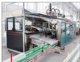
Machine de thermoformage Amut type AMP 850W-GP.
