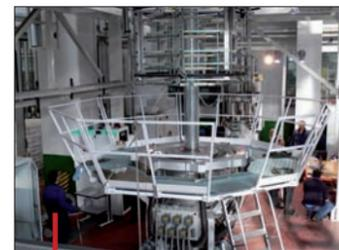
La ligne Agri Film repose sur une extrudeuse de 160 mm de diamètre de vis capable d'extruder une bulle de 7 m de diamètre.
