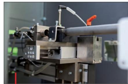
Les lopins de Liquidmetal sont fondus sous vide dans une chambre à induction avant que l'alliage ne soit injecté dans le moule.
