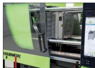
Pour mouler des pièces en LiquidMetal, Engel propose une presse tout-électrique E-Motion de 110 t, équipée d'un robot cartésien Viper.
