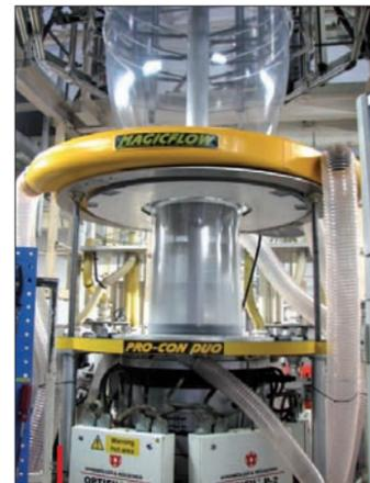
Les installations Macchi peuvent être dotées d'anneaux de refroidissement à double flux.
