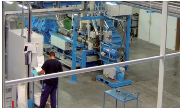
Ligne de compoundage bi-vis équipée d'une coupe en tête sous film d'eau.
