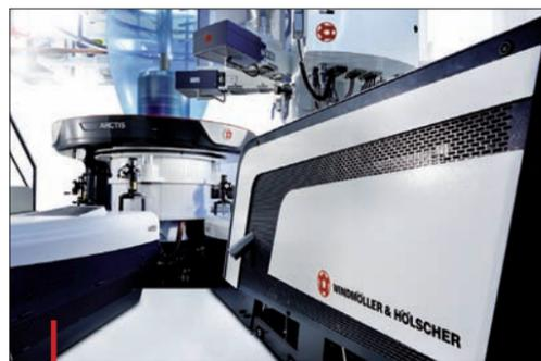
Les lignes de coextrusion Varex II sont équipées des plus récents développements de W&H en matière de têtes et filières, anneaux de refroidissement, tirages, enrouleurs et dosage-alimentation.
