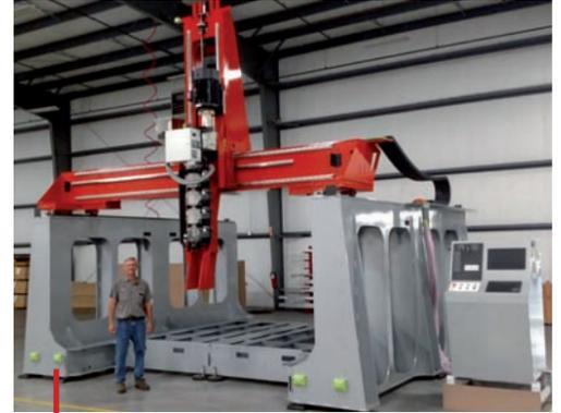
Le prototype mis au point par Thermwood peut imprimer et usiner des pièces mesurant plus de 3 m de longueur et 1,5 m de hauteur.
