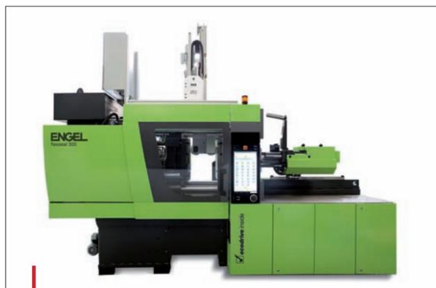
Une presse Flexseal 300 t moule 20 joints toriques en caoutchouc (poids total injecté de 75 g) en 65 s.
