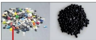
La technologie Re grindPro d'Erema permet d'obtenir des granulés de qualité à partir de déchets volumineux et sales.
