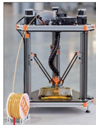
Igus s'est doté d'un parc conséquent de machines d'impression 3D par dépôt de fil fondu.
