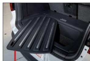
Le plancher de coffre rotatif facilite le chargement du coffre.
