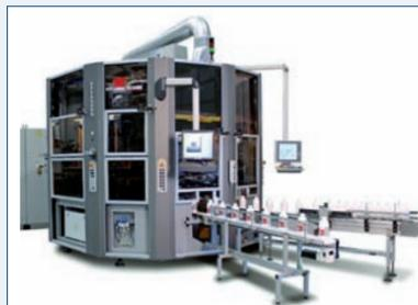
Machine de sérigraphie Isimat 5 couleurs à transfert rotatif 15 stations Isimat type RG5/RS5 équipée pour l'In Line Foiling. Elle peut décorer jusqu'à 70 flacons ou pots plastiques cylindriques, ovales et rectangulaires par minute.
