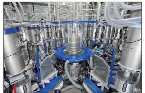
Cette installation de coextrusion 11 couches est installée dans le laboratoire d'essai de l'usine d'Ausburg.
