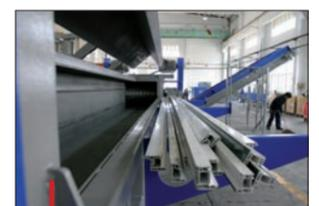
Cette station de recyclage entièrement conçue par MAT-Technologic accepte des profilés ou tubes mesurant jusqu'à 6 m de longueur.
