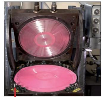
Le laboratoire de développement de Resinoplast est équipé d'une presse à disques vinyles.
