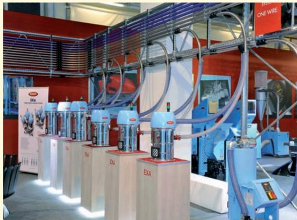
Moretto propose le système de gestion centralisé des matières auto-adaptatif One Wire. Il peut alimenter jusqu'à 80 chargeurs et trémies intermédiaires sans nécessiter de réglage manuel particulier.
