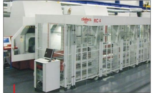
SMTO dispose d'une installation Rödgers TEC RC4 intégrant trois centres d'usinage UGV (42 000 tr/mn) en ligne (dont deux 5 axes) dans un atelier climatisé
