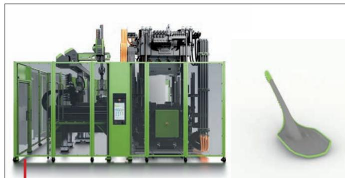
Cette cellule EasiCell équipée d'une presse v-duo 1560/700 et d'un robot Viper 40 produira une pelle ultra-résistante en composite PA 6.
