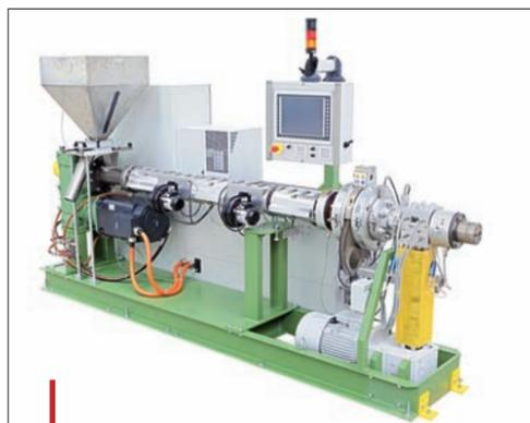
Cette extrudeuse monovis dotée d'une vis de 60 mm de diamètre en 37D de longueur est équipée d'un système de commande ME Control/3.
