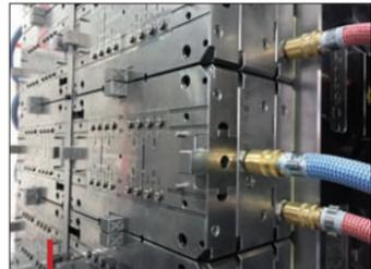
Une réalisation récente de Céma Technologies : moule 128 empreintes, conçu à partir de blocs module 16 empreintes pour dispositif médical.
