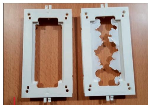
Exemple d'une même pièce moulée en matière vierge à gauche, et recyclée, à droite, sans faire intervenir un système RJG. Si on enclenche le système, les pièces moulées restent bonnes quelle que soit la qualité de la matière.
