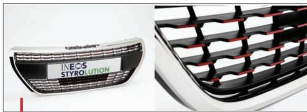
La grille avant et le cadre de la nouvelle 208 Peugeot sont moulés en ASA et ABS fournis par Ineos Styrolution. Après moulage, les pièces peuvent être peintes, chromées ou recevoir un film décor Leonard Kurz.
