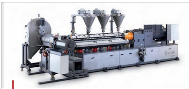
Ligne de compoundage MX 105-15 F pour la préparation de mélanges pour câbles ignifugés sans halogènes (HFFR).
