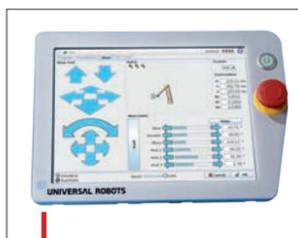
Le terminal portable développé par UR facilite grandement la programmation des cobots.
