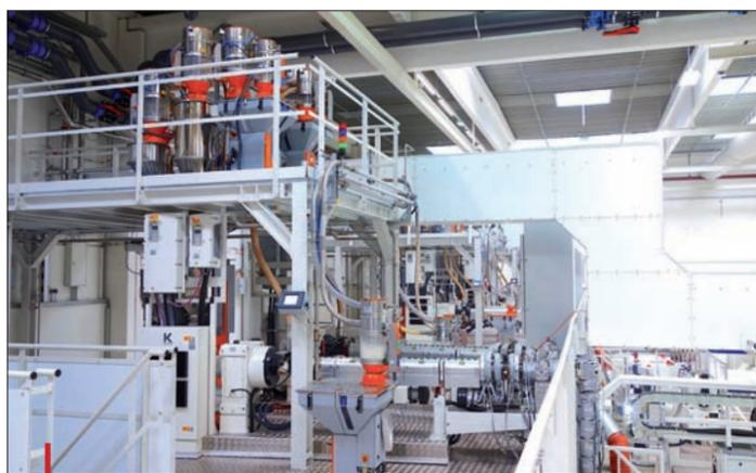
La coextrusion 7 couches nécessite 5 extrudeuses montées sur deux plateformes superposées. (ici vue de la plateforme supérieure avec ses équipements Motan).
