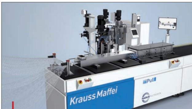
L'installation iPul de KraussMaffei combine l'injection directe de la matrice polymère et le contrôle précis du rayon de courbure des profilés pultrudés.
