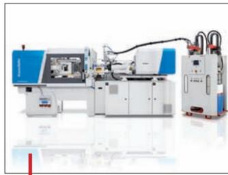
Cette machine PX 50-180 SilcoSet moule des lentilles de Fresnel en silicone liquide sans qu'aucune trace de flux ne soit visible sur la pièce.
