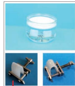
Un échantillon de PE (à gauche) immergé dans l'eau savonneuse se craquèle après 30h alors qu'un vitrimère de polyéthylène (à droite) résiste plus de 350 heures."
