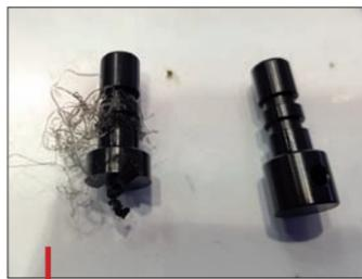
À gauche une pièce plastique usinée en mode conventionnel, à droite celle usinée en mode LFV.
