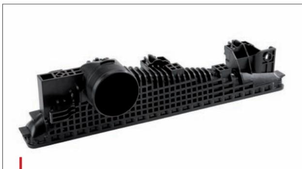
Solvay a contribué à développer la gamme des PA Technyl avec de nouveaux matériaux haute fluidité, anti-feu, haute température, etc. Ce réservoir de système de refroidissement d'un turbocompresseur d'air est moulé en Technyl REDx qui offre des propriétés mécaniques et thermiques très supérieures aux PA 6.6 conventionnels.
