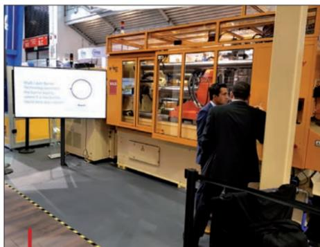
Husky présentait sa technologie multicouche à Drinktec sur une plateforme HyPET HPP5 équipée d'un moule à 72 empreintes produisant des préformes pour boisson gazeuse de 17 gm.
