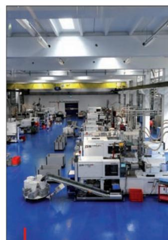
Coradin dispose d'un important parc de presses à injecter électriques.
