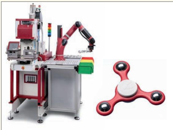
Cette cellule automatisée équipée d'un cobot Sawyer produisait des toupies à main injectées et assemblées.
