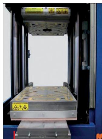
Plateaux M-TECS 240 fixés sur une presse d'injection de caoutchoucs Maplan.
