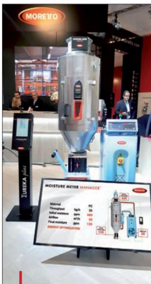
Via le pupitre du Moisture Meter Manager, l'opérateur doit simplement programmer le type de matière et le taux d'humidité résiduelle souhaité.
