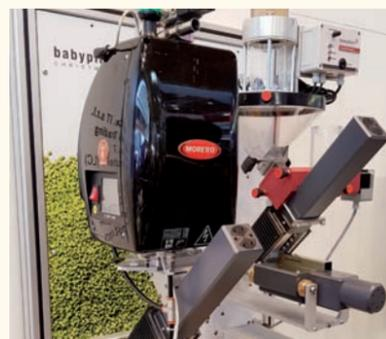
Moretto (également représenté en France par Martiplast) a développé des petits sécheurs Dry X parfaitement adaptés à la préparation des matières techniques sur les Babyplast.
