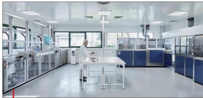
La nouvelle salle blanche ISO 8 est dédiée au nettoyage des pièces en haute propreté. À droite, la ligne conçue pour les pièces d'optique comprend un module aval de dépose de coating.
