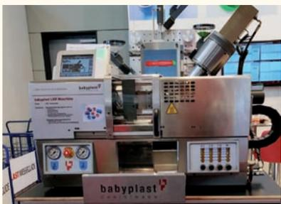
Presse Babyplast configurée pour l'injection de silicones liquides.
