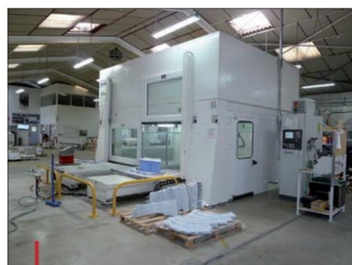
Vercors possède aussi un centre d'usinage Belotti pour pièces de 4 000 x 2 600 x 900 mm.
