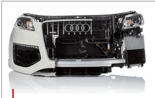
Le module bloc-avant est un ensemble complexe qui intègre la poutre d'absorption de choc, les systèmes d'éclairage et de refroidissement moteur, les volets actifs de calandre ainsi que les radars et capteurs d'aide à la conduite.
