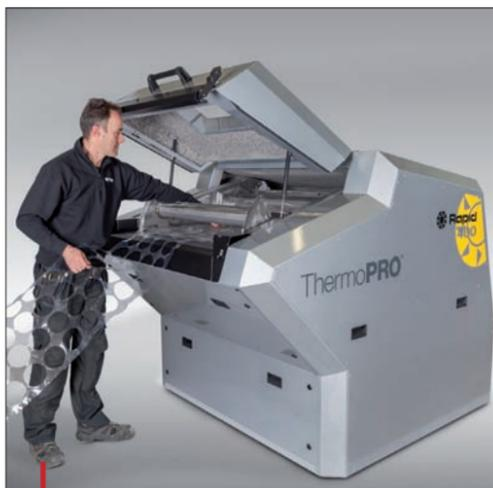
Grâce à la position basse de leur châssis, et leur conception « à cœur ouvert », les broyeurs ThermoPRO offrent un accès facile aux opérateurs de thermoformeuses.
