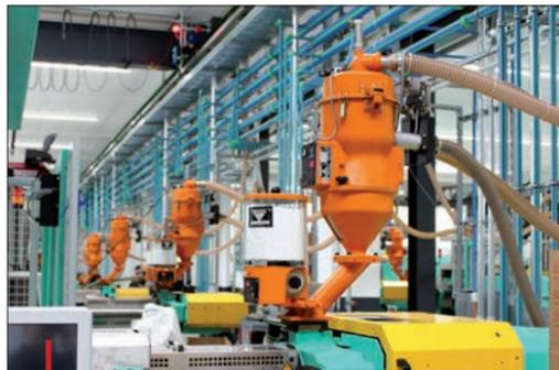
Chaque machine est équipée d'un alimentateur et d'un petit doseur volumétrique KEM.
