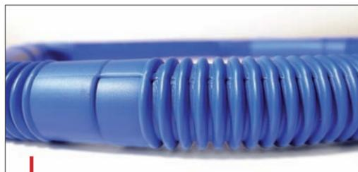
Ce tuyau annelé d'évacuation de vapeur d'essence est extrudé en PA6 Radilon S NER renforcé 35 % de f.v., mélangé à un PA industriel recyclé.
