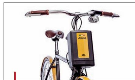
Ce boîtier batterie de vélo est moulé en alliage de PBT/ASA Pocan AF 4110
