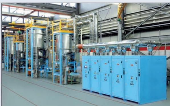
Cette installation Eureka comprend des trémies chauffantes OTX (à gauche) et des sècheurs X MAX, contrôlés par une commande Flowmatic.
