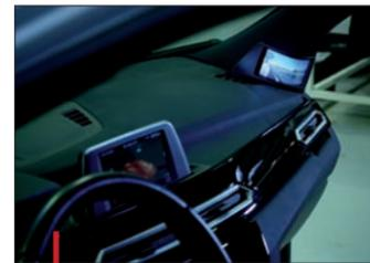
Le système FlexView associe des rétroviseurs extérieurs pivotants et une caméra de recul connectés à un écran flexible intégré dans la planche de bord.
