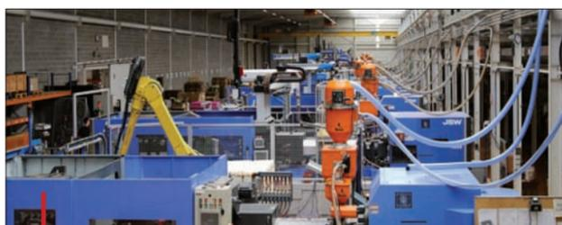
L'atelier d'injection est équipé de 27 presses de 35 à 1400 t, dont la moitié de machines tout-électriques JSW
