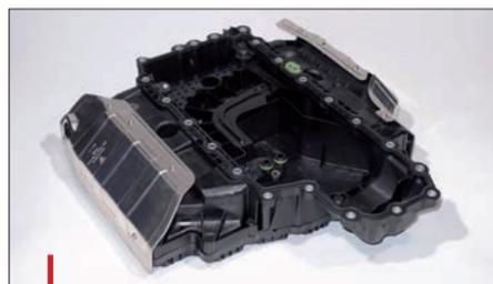
Porsche a choisi de remplacer un PA 66 par un P6 Durethan de Lanxess pour mouler ce carter d'huile de 911 Carrera.
