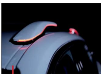
Mini barres de toit intelligentes, les Bird View pèsent la charge du véhicule et assurent une signalisation lumineuse.
