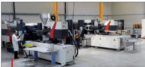
P&M dispose de deux centres d'essais dotés de presses à injecter.
