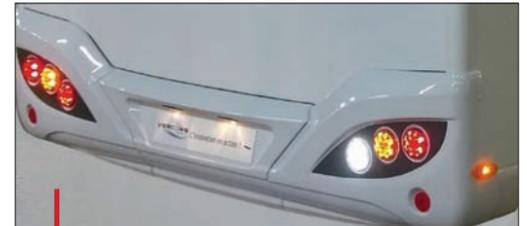
Pare-chocs de camping-car, réalisé à partir de cinq pièces thermoformées sur la même plaque, découpées ensuite sur par refente, puis assemblées (collage et soudure ultra-son) chez Vercors.
