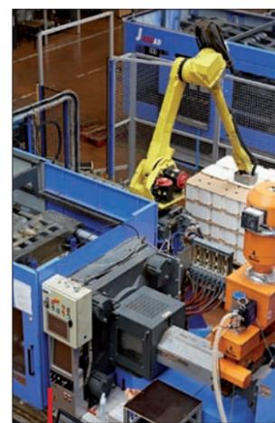
Des robots polyarticulés assurent de nombreuses tâches en sortie de presses.
