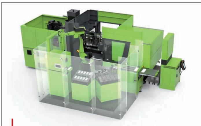
Basée sur une presse 170/120 TL équipée d'un robot 6 axes Engel eaxis, cette cellule intègre un système de changement automatique d'inserts de moules.
