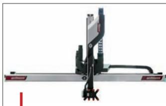
Les robots WX peuvent équiper des presses de 150 à 500 t, en emportant des pièces pesant jusqu'à 15 kg.
