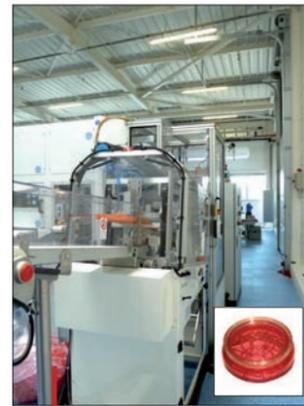
Les boîtes de Petri à 3 pièces sont produites en un cycle sur une presse JSW dotée d'une unité d'injection additionnelle.
