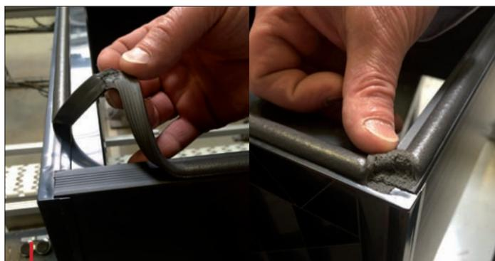
Le corona par Effluage Indirect assure une parfaite tenue de la mousse sur son support polymère.
