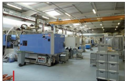
L'atelier pour la production de pièces techniques comme les composants de pipettes dont le corps est moulé avec injection gaz pour réduire le temps de cycle.
