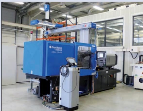
La cellule de moulage de LSR installée chez SMP est équipée d'une presse Sumitomo (SHI) Demag de 130 t dotée de tous les périphériques nécessaires à la mise en oeuvre de ces matériaux.
