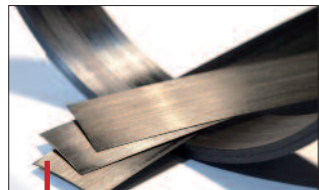
Les bandes composites en PEKK renforcé f.c. longues ont des propriétés mécaniques supérieures à celles produites sur matrice époxy.
