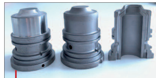
Noyau hybride constitué d'une préforme et d'une partie moulante imprimée par fusion laser sélective. (commettant Mahévas).
