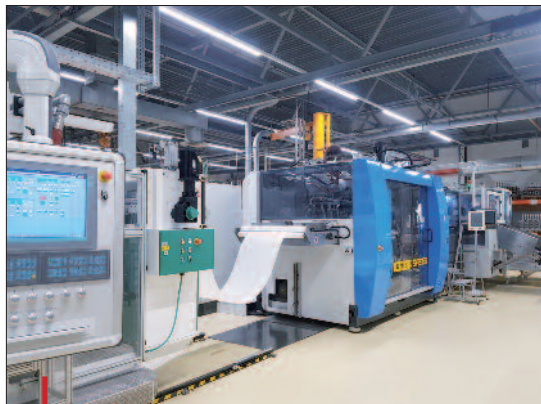
La thermoformeuse Kiefel KTR 5 Speed est alimentée directement par une ligne de coextrusion de feuilles Kuhne.
