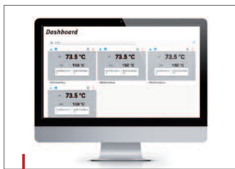
La système réseau Smart Line permet notamment d'afficher sur un même écran les données générées par plusieurs régulateurs.
