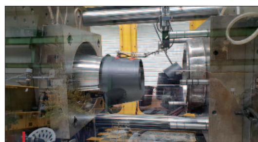
Ces seaux en PE étaient injectés sur une presse Easymaster de 560 t.
