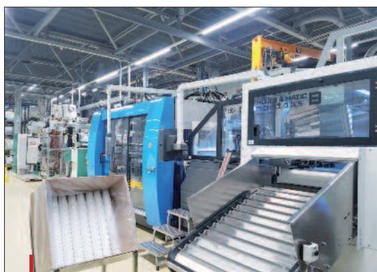
Le système d'empilage des pièces et leur évacuation a été conçu sur mesures par la filiale de Kiefel Mould & Matic.
