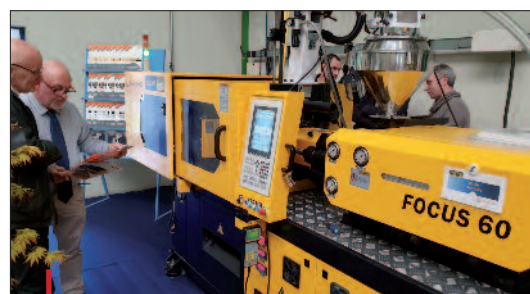
Toutes les presses sont équipées d'une commande B&R entièrement francisée.
