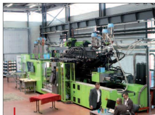
Le centre technique est doté d'une presse Engel Duo 750 suréquipée, adaptable à toutes les configurations en multi-injection.
