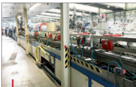
Les profilés fenêtres demandent souvent des coextrusions, notamment pour les joints d'étanchéité.
