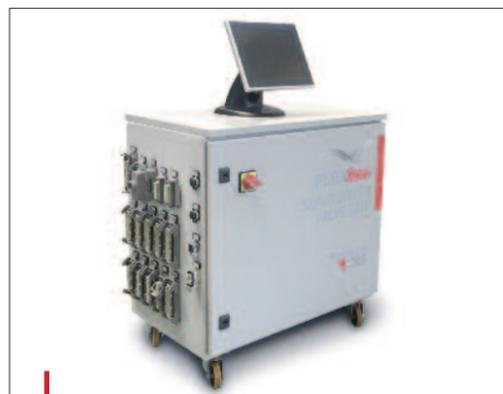
La commande centralisée d'injection séquentielle FLEXflow peut gérer jusqu'à 6 capteurs de pression. En 9 configurations disponibles, pour contrôler de 4 à 24 vérins d'obturation.
