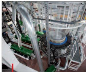
Ligne de co-extrusion POD Macchi.
