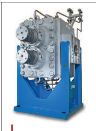
La capacité de transport spécifique des pompes Polyrex x6 est jusqu'à 50 % plus élevée que celle des pompes de même taille de précédente génération.
