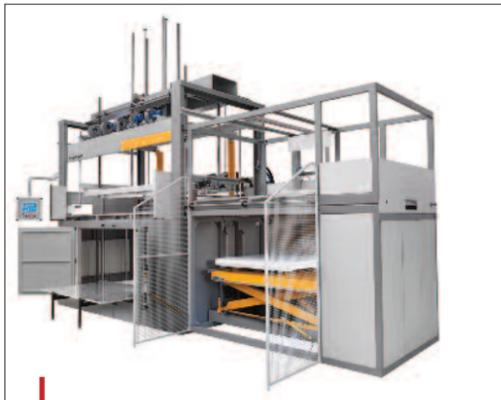
Les thermoformeuses Terma assurent en mode automatique le chargement des plaques et le déchargement après formage.
