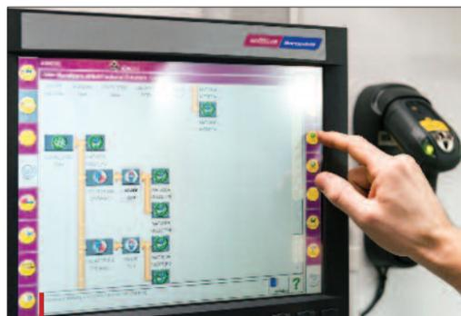
Système de contrôle du réseau Wittmann M7.3 IPC. Le scanner de codes-barres permet de gérer les flux de matières de leurs sources jusqu'aux presses à injecter.
