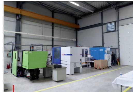
Le parc machine du centre d'essai. À droite, la presse 200 t produisant des pots de crème glacée décorés par IML.
