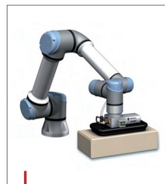
Ce cobot UR est équipé d'un caisson CVGC fourni par Coval.
