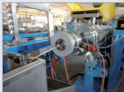
Ligne d'extrusion de tubes médicaux Tecno System.
