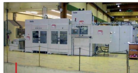
Machine de thermoformage épais Illig UA 100g.
