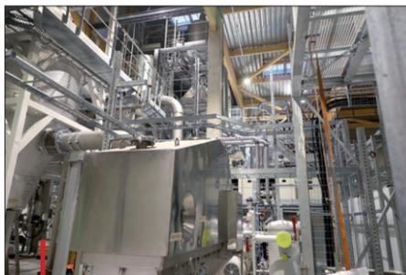
L'unité de polycondensation à l'état solide assistée sous vide Polymetrix permet la décontamination et la remontée de l'IV de la matière recyclée.
