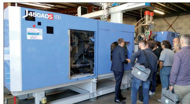
Presse JSW 450 t, équipée d'un système doseur Movacolor.
