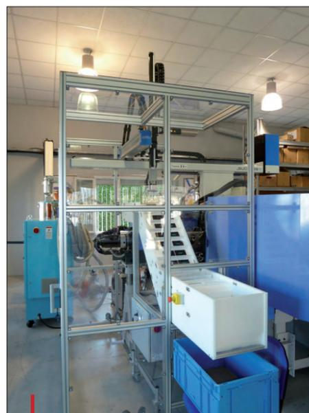
Presse JSW 100 t dotée de la nouvelle unité d'injection auxiliaire FLIP 20 et d'un convoyeur Farpi Syscon pour l'évacuation et la mise en caisse des pièces.
