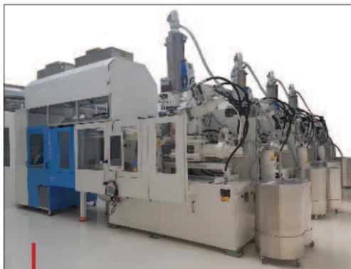
L'atelier est équipé de 4 presses électriques sous ISO 7.
