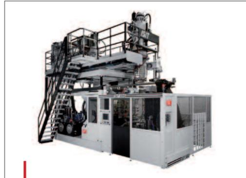
Une machine d'extrusion-soufflage 2D pour la production de pièces de grandes dimensions sera prochainement installée à La Forêt-Fouesnant.
