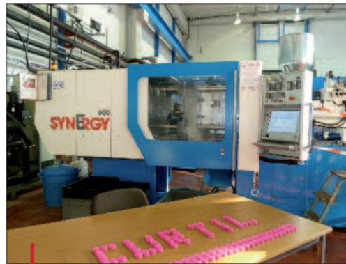
Curtil Mold dispose d'un centre d'essai et de mise au point équipé de presses pour l'injection haute cadence.
