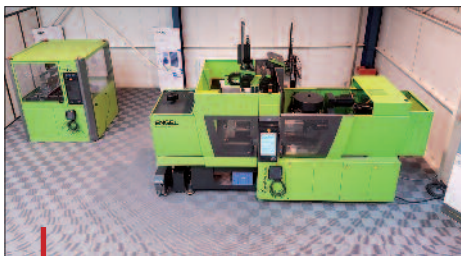
La commande de presse e-victory 80 t intègre les principaux logiciels d'optimisation de process développés par Engel.
