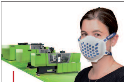
Ce masque réutilisable comprend deux éléments injectés en TPE sur presse Engel.
