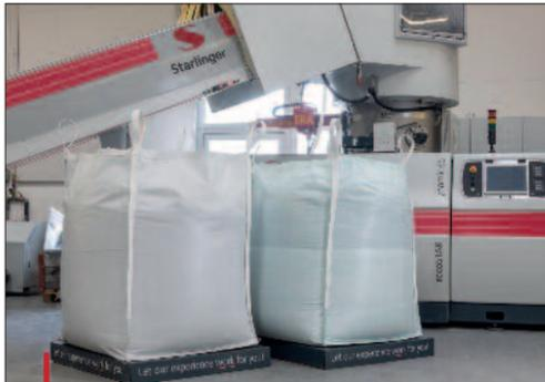
La technologie recoSTAR Dynamic avec unité de dégazage C-VAC permet de produire du rPP pratiquement identique au PP vierge.
