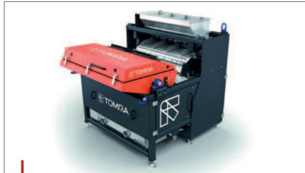
Le système Autosort Flake de Tomra Sorting détecte simultanément, avec une seule machine, la couleur, les métaux etc., quelle que soit la granulométrie des flux entrants.
