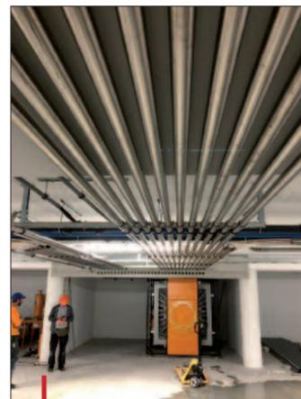
Le système Navigator assure la gestion centralisée, sans risque de contamination ni erreur d'aiguillage des différents granulés.
