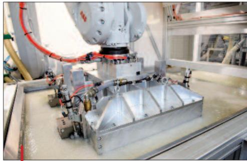
La formuse KFT 90 est équipée en amont d'un système d'aspiration de liquide et de transfert robotisé des fibres résiduelles.
