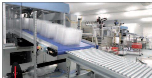
Lignes de thermoformeuses à bobines TFT en salle ISO 7 jusqu'à 1000 x 700 mm
