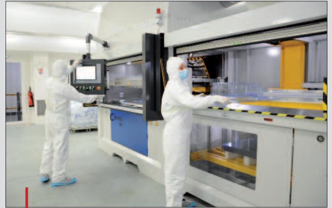
La nouvelle Geiss Ts1 équipée d'une centrale de traitement d'air imaginée par les techniciens de Top Clean Packaging pour la fabrication en salle ISO 7 de blisters et plateaux médicaux très grand format de 0,5 à 8 mm d'épaisseur
