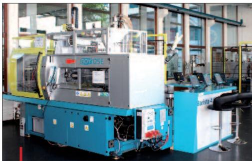
Cellule robotisée comprenant une presse Boy 125 E équipée d'une unité auxiliaire 2C S.
