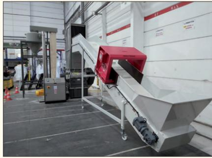
Une solution Martiplast typique : un convoyeur équipé d'un tunnel de détection de métaux alimentant un broyeur Genox GXC 800.
