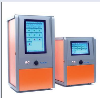
Les coffrets GC permettent une injection sans ligne de soudure, la réduction des rebuts, la répétabilité process et une traçabilité de la production conforme aux exigences les plus élevées des secteurs automobiles et techniques.
