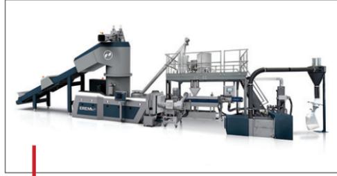
La technologie Corema associe recyclage et compoundage sur bivis corotative.
