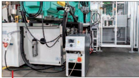
Le régulateur P160M peut être facilement positionné au plus près de la presse.
