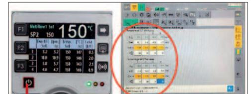
Les paramètres de température peuvent être gérés au choix, sur le thermorégulateur Regloplas, ou via la commande de presse Arburg.
