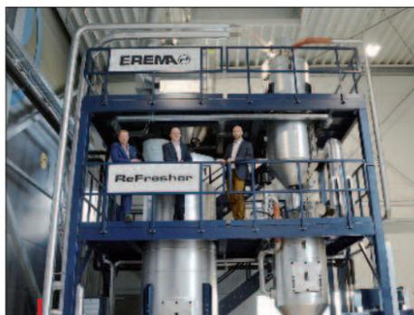
Erema met à disposition de ses clients une installation d'essais ReFresher.
