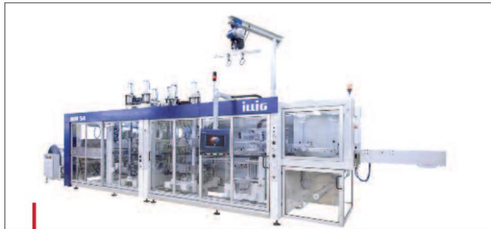
Grâce à leur conception modulaire, les thermoformeuses Illig peuvent aisément intégrer un poste d'IML-T.
