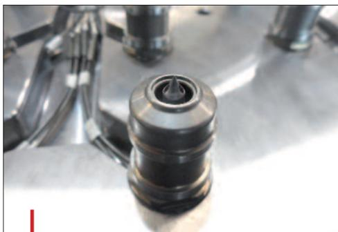
Buse TF munie d'un insert de seuil D-Bushing.
