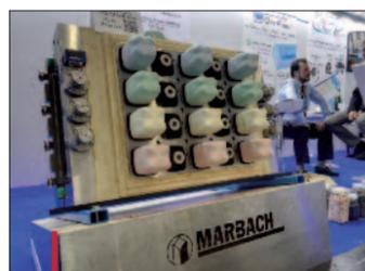
Exemple de moule de thermoformage équipé de poinçons d'assistance fournis par CGP Europe.
