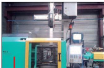
Cellule d'essai et de mise au point des outillages, dotée d'une presse 110 t Allrounder Arburg et d'un robot Sepro particulier.
