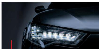
Grâce à des grades transparents spéciaux, les LSR sont mis de plus en plus à contribution dans la réalisation des phares automobiles à LED.
