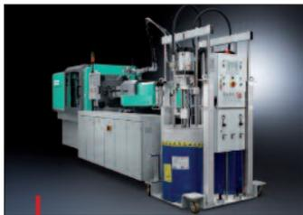
Cellule complète d'injection de LSR basée sur une presse Allrounder.
