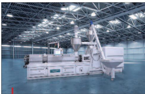
Extrudeuse double-vis contrarotative type MD de Bausano.
