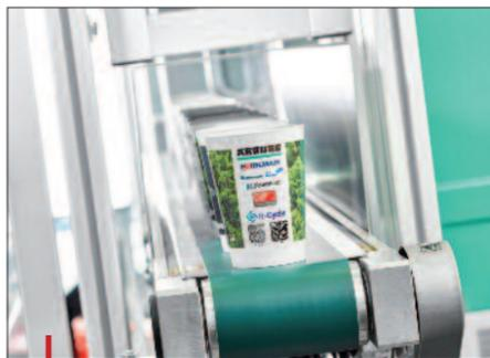
Cette ligne Arburg injecte des gobelets en PP recyclé doté chacun d'un code d'identification R-Cycle unique imprimé.
