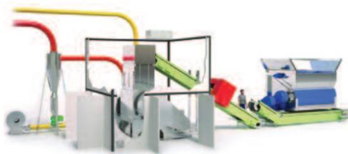
Mise en application des dernières technologies de broyage : broyeurs à couteaux, broyeurs à vitesse lente et déchiqueteurs monorotors à poussoir.
