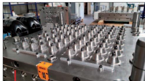
Mahévas a développé des systèmes de dévissage anti-grippage tout-électriques.
