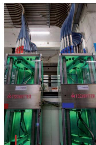
Le système d'aiguillage robotisé garantit une alimentation matière des extrudeuses sans erreur.
