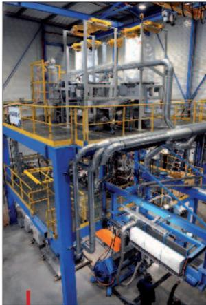
La nouvelle ligne Leistritz permet de réaliser en extrusion réactive des opérations de compoundage complexes.
