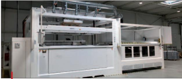
Cette thermoformeuse tout-électrique Geiss T10, installée chez Vercors, peut produire des pièces mesurant plus de jusqu'à 3,5 m de long.
