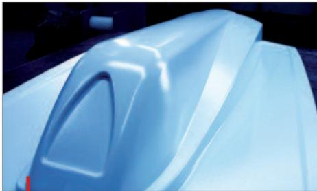
Le thermoformage profond permet de créer des pièces aux formes innovantes.
