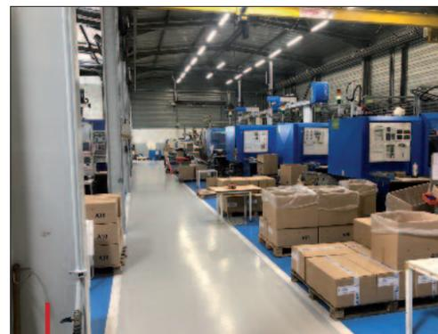
BG Plastic est équipé d'une série de presses Sumitomo-Demag tout-électrique de la gamme IntElect.
