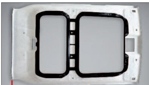
Le nouveau concept permet de gagner jusqu'à 60% en poids par rapport à une armature métallique.
