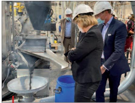
Sortie des granulés purs à 97% en bout de ligne de recyclage.
