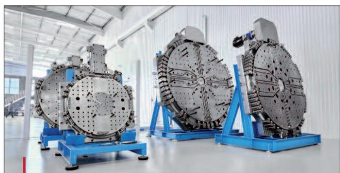
Le centre d'essais de moules est équipé de tables et bases tournantes de grande taille.
