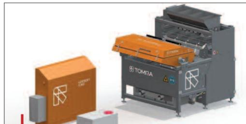
L'Autosort Flake analyse et trie les flocons en fonction de leur couleur et de leur matériau. Un spectromètre visible (VIS) détecte les contaminants colorés. Le spectromètre proche infrarouge (NIR) assure quant à lui la détection de matériaux. Une d'éjection courte assure un tri très précis.
