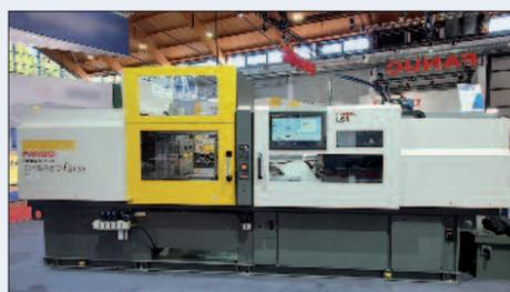
Presse  $\alpha$ -S150iB configurée pour mouler des pièces en LSR en mode automatisé.
