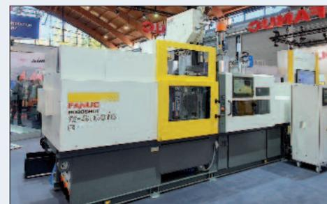
Cette  $\alpha$ -S150iB était équipée d'une unité d'injection auxiliaire S20iA.
