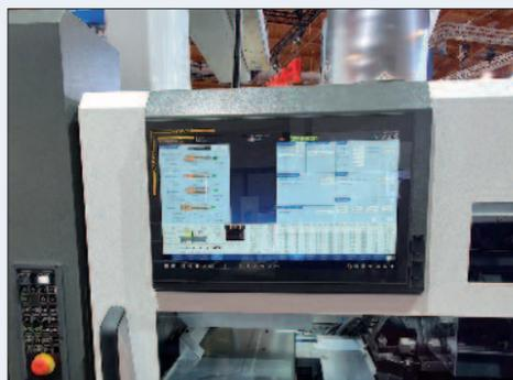
La nouvelle commande FANUC iH Pro permet d'afficher deux pages écran simultanément.
