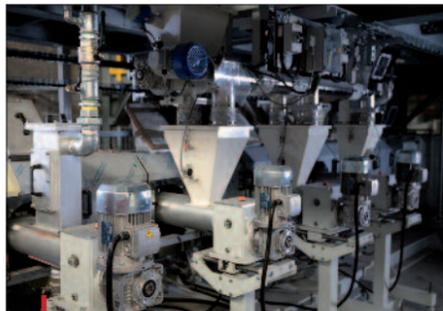
Les extrudeuses sont équipées pour recevoir différents types d'additifs à différentes étapes de la plastification des matières.
