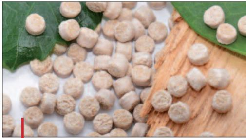
Les nouvelles lignes d'extrusion Bausano garantissent l'obtention de demi-produits ou de granulés plastiques-fibres naturelles très homogènes.
