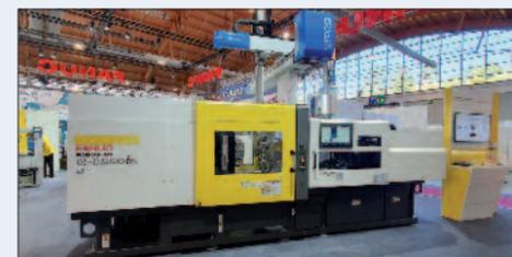
Cette presse  $\alpha$ -S220iB est actuellement la plus puissante de la nouvelle gamme qui montera jusqu'à 450 t de force de fermeture dans la courant de l'année 2022.
