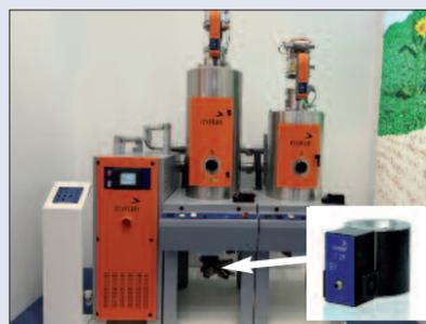
Le Moisture Minder est monté sous la trémie de séchage.
