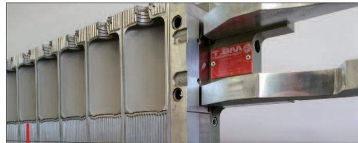
Moule pour machine d'extrusion-soufflage à course longue.
