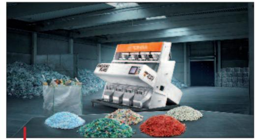
Avec sa largeur de tri en continu de 2 000 mm, l'Innosort Flake peut trier jusqu'à 6 t/h de flocons de PET ou polyoléfines, avec seulement 2% de pertes.
