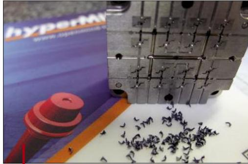
Bloc 16 empreintes moulant un actionneur mesurant moins de 2 mm.
