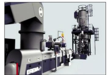
La technologie Refresher d'Erema permet d'éliminer les odeurs résiduelles des plastiques recyclés, PE notamment.
