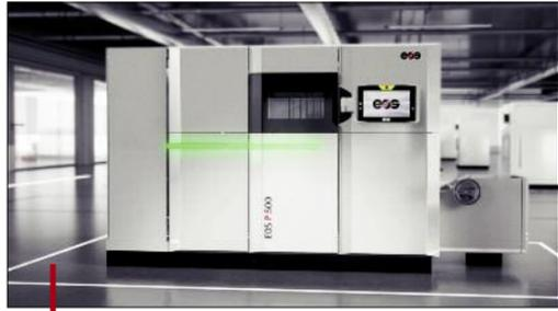
Dotée d'un double laser, l'EOS P500 apporte une disponibilité en production jusqu'à 75% supérieure aux modèles mono-laser équivalents.
