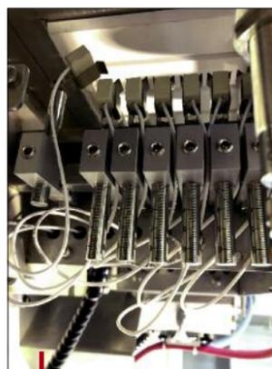
La hauteur des lampes chauffantes peut être réglée très précisément en fonction de la hauteur et de la forme de chaque type de préformes.
