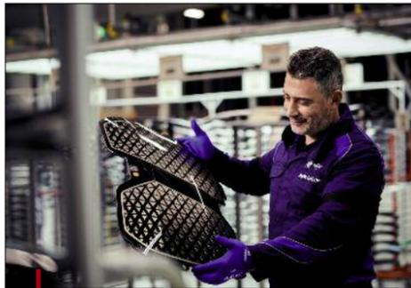
Les calandres de la nouvelle BMW iX sont fabriquées en salle blanche dans une cellule développée et installée par Engel.
