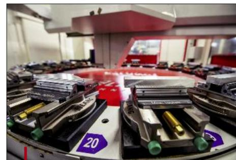
Le robot chargeur Lang Technik à 20 états de fixation en ligne avec la Mazac 5 axes assure une excellente productivité et flexibilité à l'entreprise.
