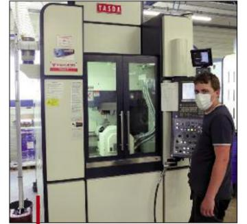
Ce centre d'usinage Yasda 5 axes est piloté par le logiciel de FAO hyperMILL.
