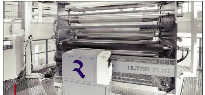
La technologie Ultra Flat développée par Reifenhäuser permet d'extruder des films très fins qui induisent une réduction de l'empreinte carbone des emballages plastiques.
