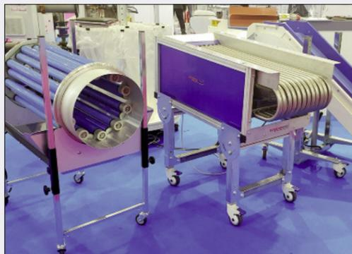
Les matériels Virginio et MTF Technik assurent le convoyage, le tri et le conditionnement des pièces moulées en aval des presses.
