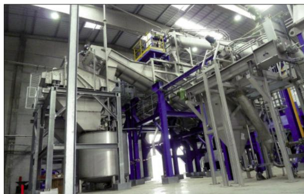
L'usine de Halluin est dotée d'équipements sophistiqués (qu'elle a en partie conçus) de séparation densimétrique et optoélectronique des différents polymères qu'elle recycle.
