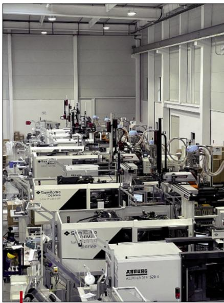
L'atelier est équipé de différents types de presses Sumitomo-Demag, hybrides cadences rapides Systec SP et El-Exis SP, et tout-électriques IntElec.
