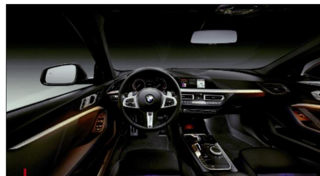
Les deux baguettes latérales ainsi que la baguette frontale, toutes rétro-éclairées, de cet intérieur de véhicule BMW sont moulées en Alcom LD (light diffusion) et Alcom LB (light blocking). (Photo BMW Group)
