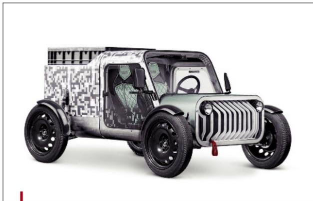
Offrant une grande capacité de chargement, la Bagnole peut être équipée au choix d'une benne en bois sur mesure ou d'une caisse en PEhd recyclé.
