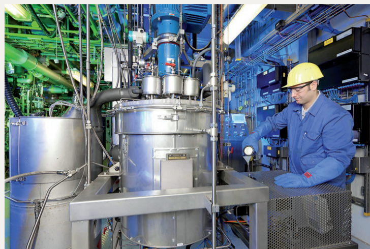
Unité pilote pour l'obtention de PPP à partir de CO 2 . Une innovation majeure pour la production des PUR de demain.
