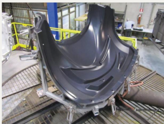
Le bouclier avant est moulé d'une seule pièce sur une installation Leonardo du constructeur italien Persico.
