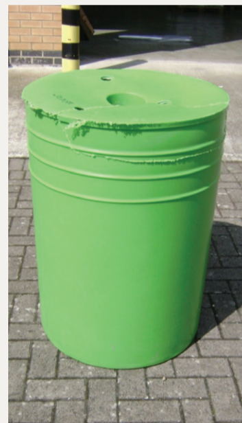
Pièces échantillons qui ont permis de mesurer l'aptitude à la transformation du nouveau grade.
