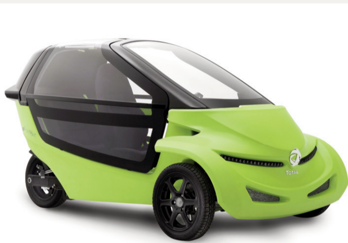
Le concept-car Bio-TPSeal : un véhicule ultra-léger pour la mobilité urbaine de demain. La carrosserie peut être peinte ou colorée par mélange-maître poudre.
