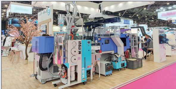
Presse JSW équipée d'un double système de recyclage en ligne Matsui et d'un robot Yushin.
