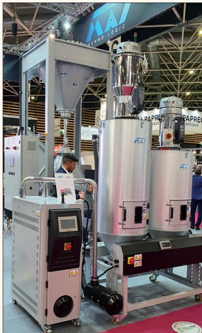
Avec les dessiccateurs PLASTIC SYSTEMS et les trémies de sa fabrication, MAT peut proposer des stations de séchage spécifiquement adaptées aux besoins.
