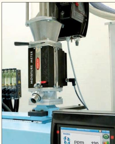
Les deux éléments constitutifs du Moisture Meter, le système de mesure et le pupitre de commande.
