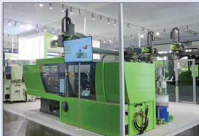
**Presse sans colonne Victory 160 t Combi produisant un diaphragme de réservoir en PBT renforcé f.v. surmoulé par un LSR auto-adhésif.**
