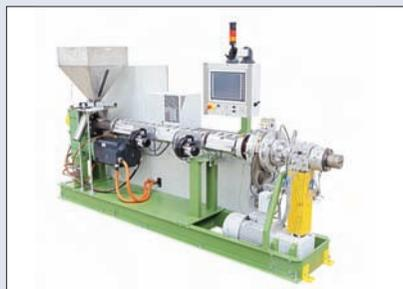
Extrudeuse monovis IDE (60 mm x 37D) équipée d'un système de commande ME Control/3.
