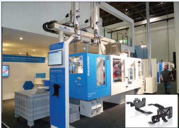
Cellule d'injection de matières renforcées FiberForm sur une CX-300. Le code QR figurant sur chaque pièce donne accès aux paramètres de réalisation sur chaque cycle, notamment les courbes de chauffage des inserts et de vitesse et pression d'injection.
