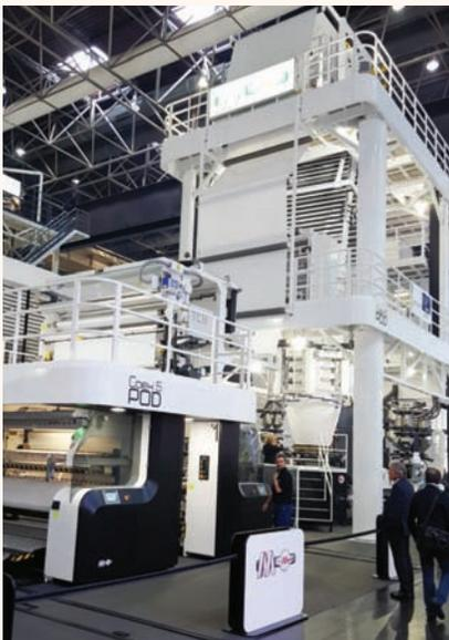
Macchi exposait une ligne POD de coextrusion de films 5 couches en différents PE.
