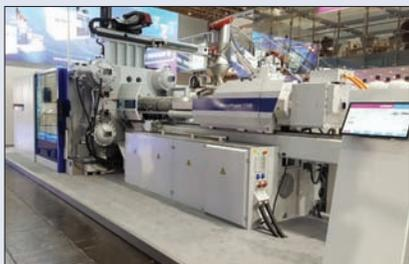
Cette presse MacroPower 1100 t moule une pièce automobile avec le procédé d'injection gaz Cellmould.
