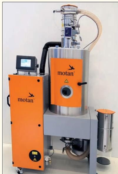
Les sècheurs Luxor sont dotés d'un écran de commande tactile qui facilite leur paramétrage.
