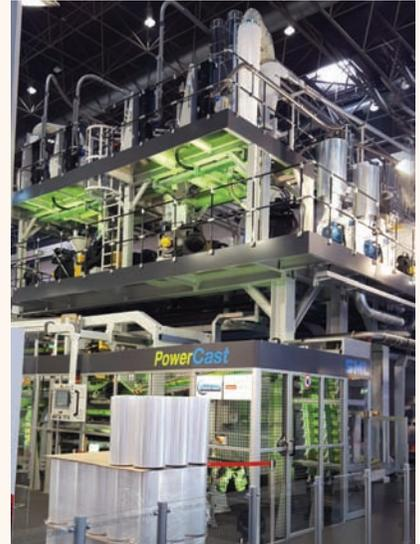
Ligne de coextrusion de feuilles 13 couches PowerCast SML.
