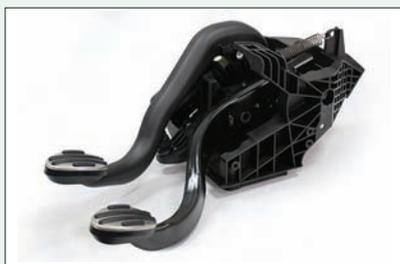
Pédale d'embrayage injectée avec assistance eau en Akromid B3 ICF 15 renforcé f.c.
