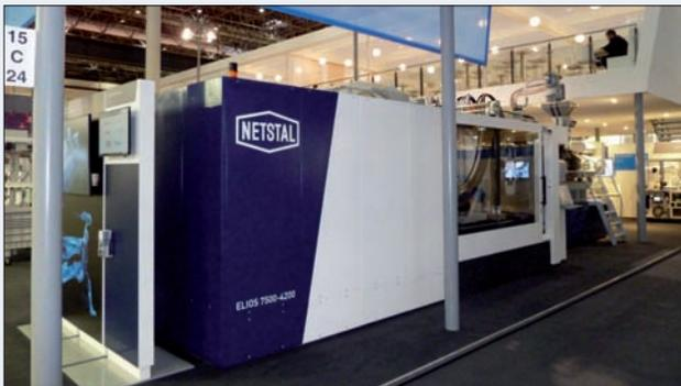
La nouvelle presse Elios 7500, la haute cadence avec une presse de 750 t.
