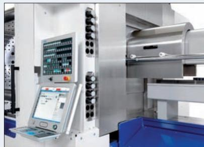
Les presses Netstal sont désormais équipées de la commande Axos 8 dotée d'un double écran, tactile et à touches physiques.
