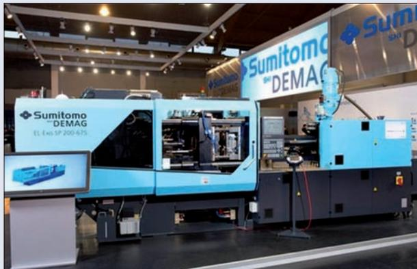
Presse EI-Exis SP 200 produisant 4 pots en PP décorés par IML dans un temps de cycle inférieur à 2 s.
