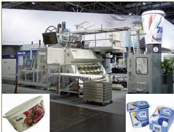
**Cette station automatique IML RDML 70b peut poser tous types d'étiquettes. La technologie IML-T d'Illig applique des décors de haute qualité à des pots ayant des géométries variées.**
