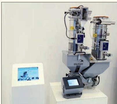
Ce doseur-mélangeur volumétrique compact Mini-color est doté d'un chargeur centralisé.
