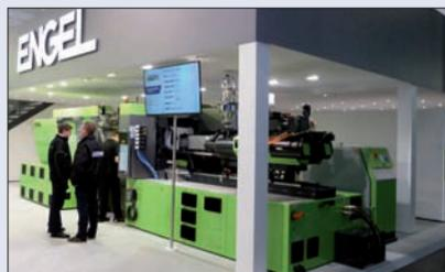
**Cellule d'injection-soufflage basée sur une presse-e-motion 220 t équipée d'un moule-cube Foboha à 8 empreintes.**
