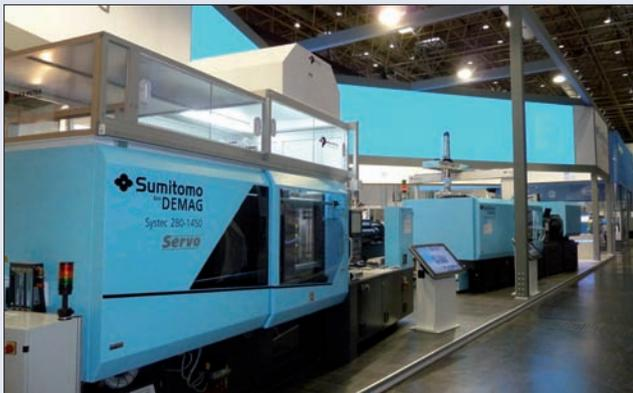
Le stand côté injection pièces techniques, avec au premier plan une machine hybride Systemic Servo de 280 t dotée d'une enceinte à flux laminaire pour moulages propres.
