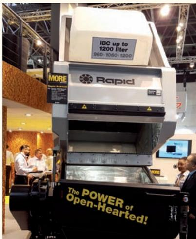
**L'installation Raptor + broyeur LBB est parfaitement adaptée au recyclage de conteneurs industriels IBC de 1 200 l de capacité.**
