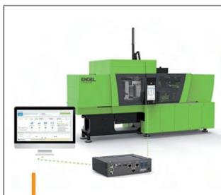
Le module logiciel iQ Weight optimise en temps réel le poids matière injecté cycle après cycle.
