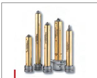
Sur les buses FN de Thermoplay, résistances et thermocouples peuvent être remplacés sans démonter le moule.
