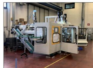
Machine d'extrusion-soufflage Meccanoplastica tout-électrique HE550.
