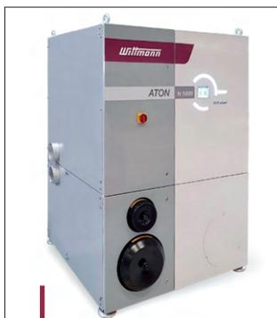
**Aton H1000, une solution Wittmann pour le séchage centralisé.**
