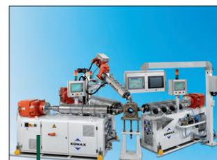
Ligne de coextrusion pour profilés automobiles PP-TPE, dotée de machines à technologie Helibar.
