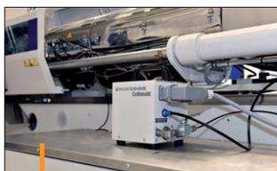
Cette presse MacroPower est équipée d'un système CellMould de moussage par injection d'azote sous haute pression.
