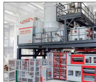
Cette ligne de coextrusion cast Amut ACS 2000 peut produire des films ayant jusqu'à 7 couches en 2 000 mm de laize.
