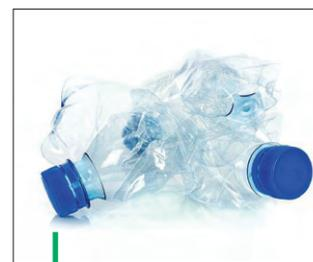
Les compounds PBT LNP Elcrin IQ sont produits à partir de déchets de bouteilles PET recyclés chimiquement.
