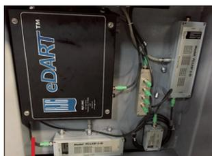
Les boîtiers de pilotage eDart recevant les mesures de pression des capteurs forment le cœur de la technologie RJG.
