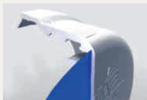
Bouchon en PP de 38 mm de diamètre avec bague d'invulnérabilité pour bouteille remplissable à chaud. En bleu, la couche barrière à l'oxygène de 0,1 mm d'épaisseur en EVOH
