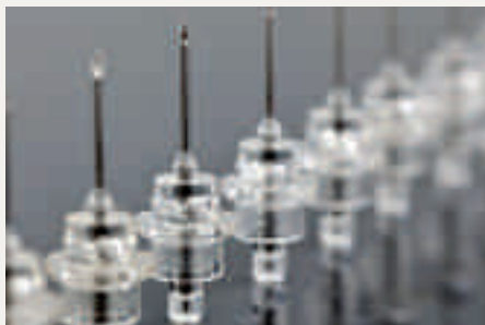
Outre le moule 24 empreintes de surmoulage d'aiguilles, SMP a mis au point l'automatisation complète du process de fabrication.
